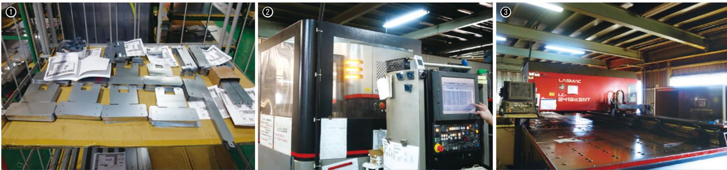
① ACIES-AJで加工したブランク材 / ② パンチ・レーザ複合マシン LC-2012C1NT+AS-2512C1 / ③ レーザマシン LC-2415αIII NT+LMP-2412α
