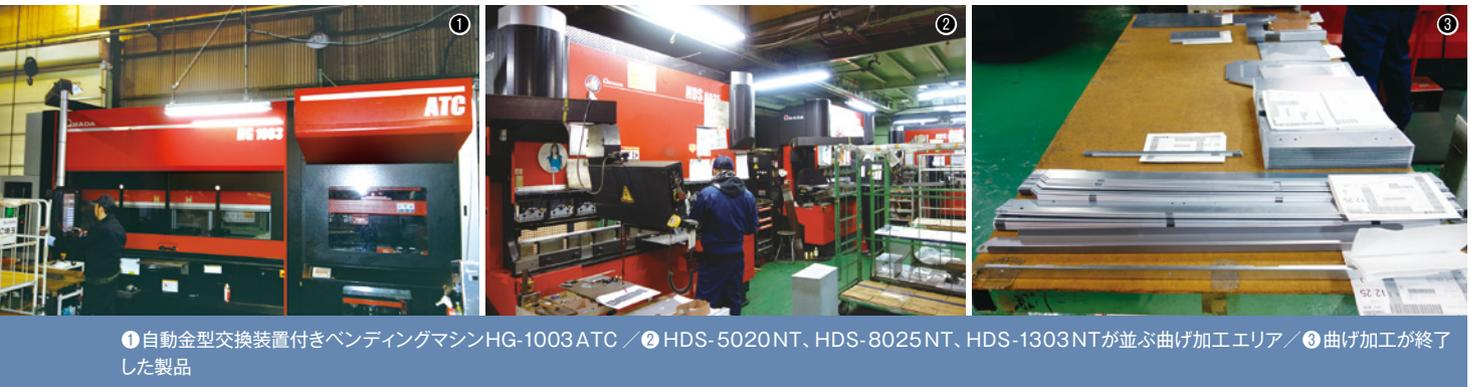
① 自動金型交換装置付きベンディングマシンHG-1003 ATC / ② HDS-5020NT、HDS-8025NT、HDS-1303NTが並ぶ曲げ加工エリア / ③ 曲げ加工が終了した製品
