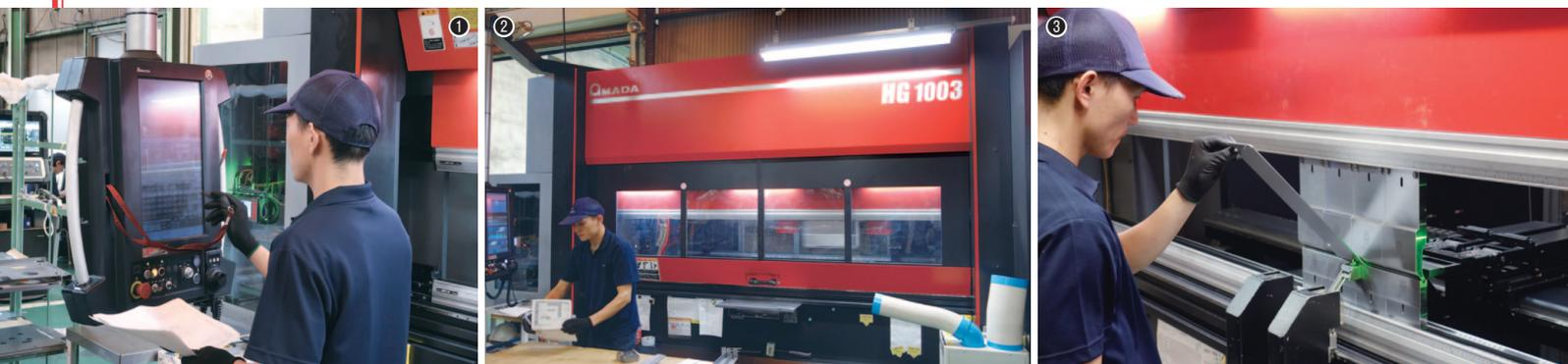
①AMNC3iはスマートフォンのような直感的操作が可能／②自動金型交換中に次の作業の確認などを行える／③HG-ATCの曲げ作業はベトナム人の高度人材が担当。Bi-Sが加工品質を一定に保つ
