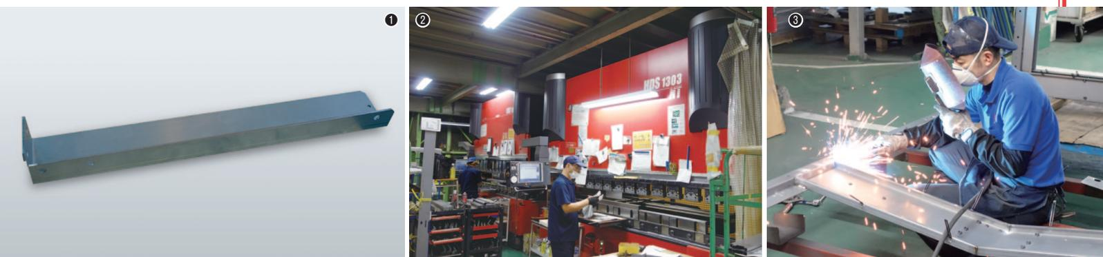
①HG-ATCで曲げ加工した製品。厚さは3.2mm以下が殆ど／②HDS-1303NT×2などベンディングマシンは計9台設置／③溶接作業
